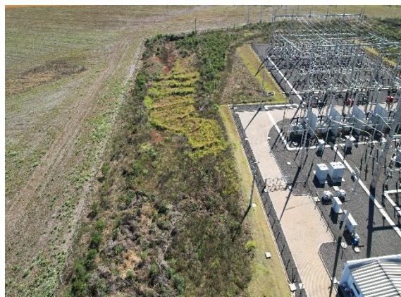
Figura 1.3.14. Vista aérea da área AA 0004 revegetada, com curvas de níveis e bacia de contenção (junho de 2023).
