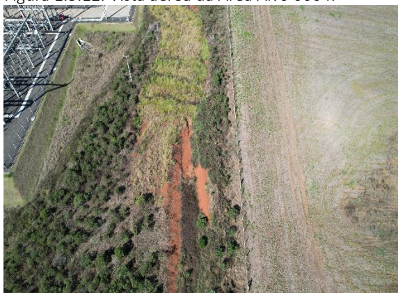
Figura 1.3.13. Vista aérea da área AA 0004 revegetada, com curvas de níveis e bacia de contenção (junho de 2023).
